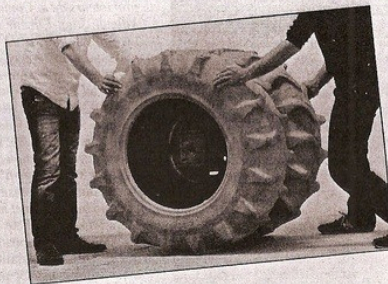
Les crash box, gros pneus de tracteurs munis de petites caméras, recueilleront les images, in vivo, du foudroyage. Crédit : Gasc démolition.
